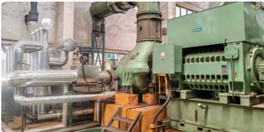
河南中原冶炼厂蒸汽轮机和电动机配合驱动空压机机组将余热转化为能源
