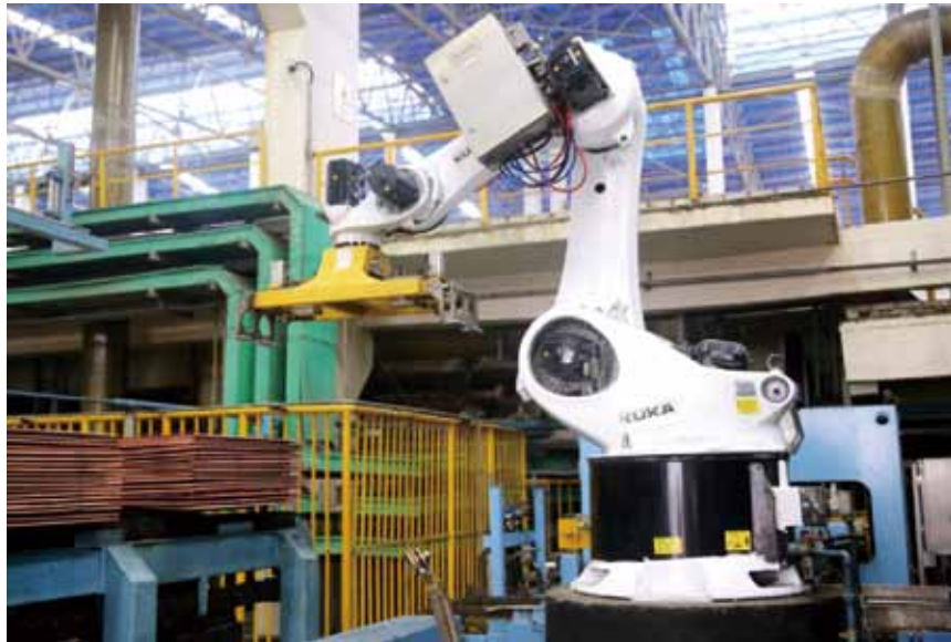
中国黄金集团中原冶炼厂已成为亚洲最大的黄金综合回收基地。图为中原冶炼厂自动剥板机器人。
